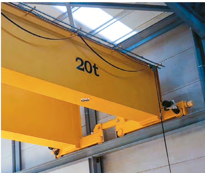
SUWNICA Z PODWÓJNYMI CZOŁOWNICAMI (OSIEM KÓŁ).
