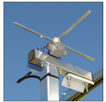
5 Final de carrera traslación puente
