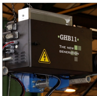
17 Armario eléctrico polipasto
