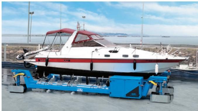
Questo sistema consente di muovere facilmente le imbarcazioni nel bacino di carenaggio, sia per le attività di stoccaggio che per quelle di revisione e manutenzione.
