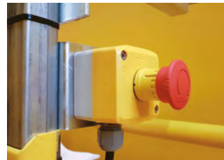
SETAS DE EMERGENCIA
