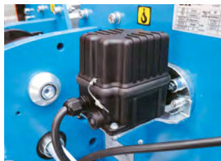
FINAL DE CARRERA ELEVACIÓN
